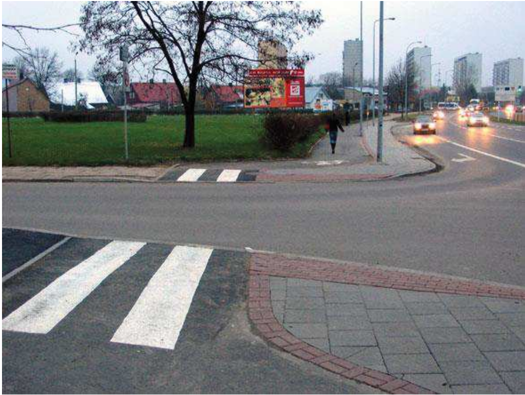
Ilustracja 23. Nieprawidłowe odgięcie trasy rowerowej na skrzyżowaniu
