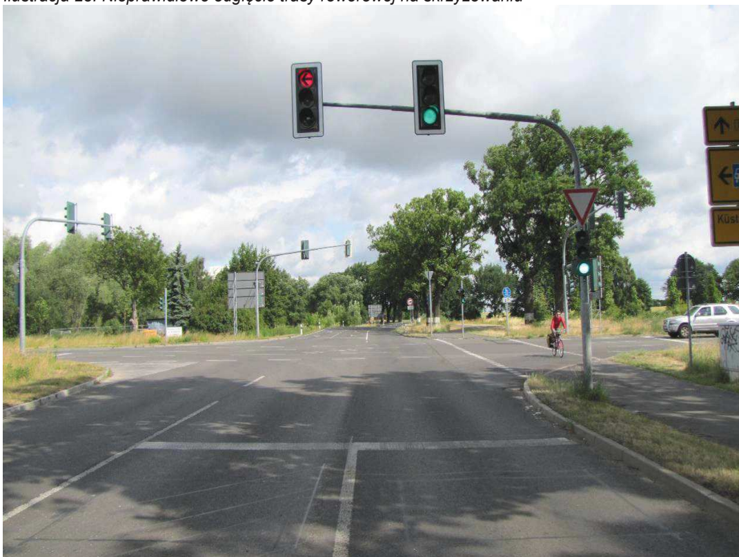
Ilustracja 24. Prawidłowe przeprowadzenie trasy rowerowej przez skrzyżowanie
