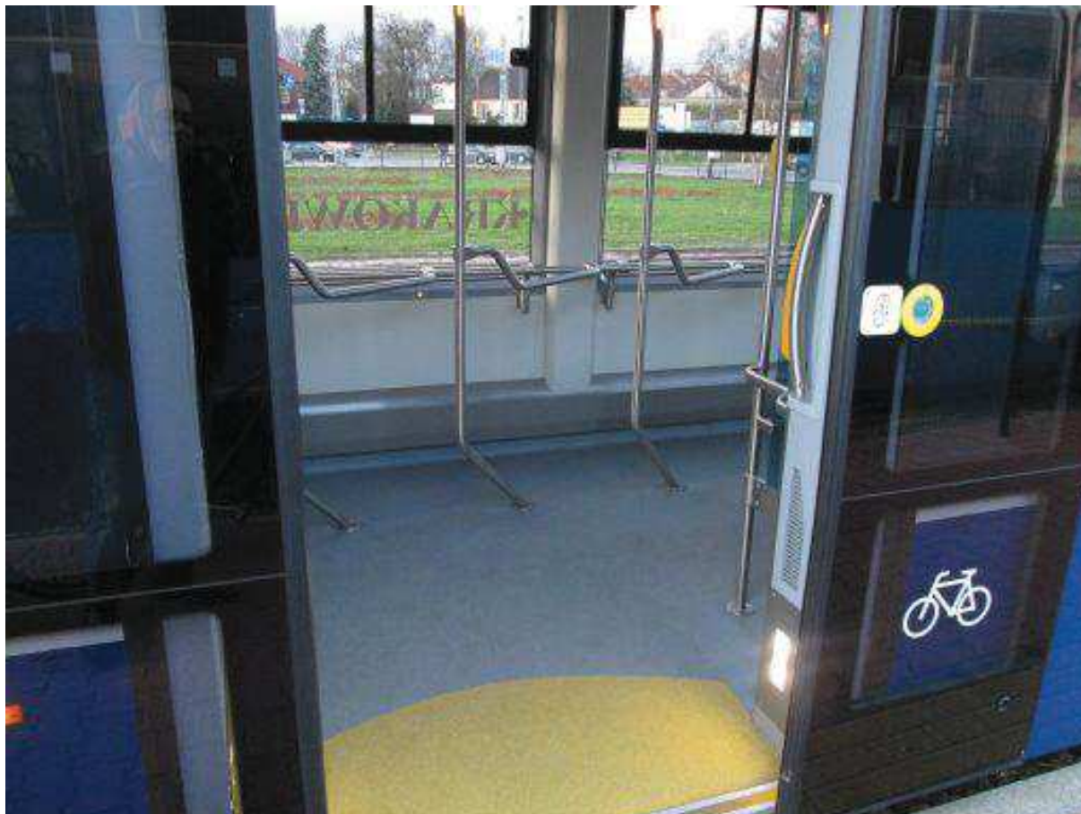
Ilustracja 36. Stojaki do przewozu rowerów - tramwaj PESA „Krakowiak”
