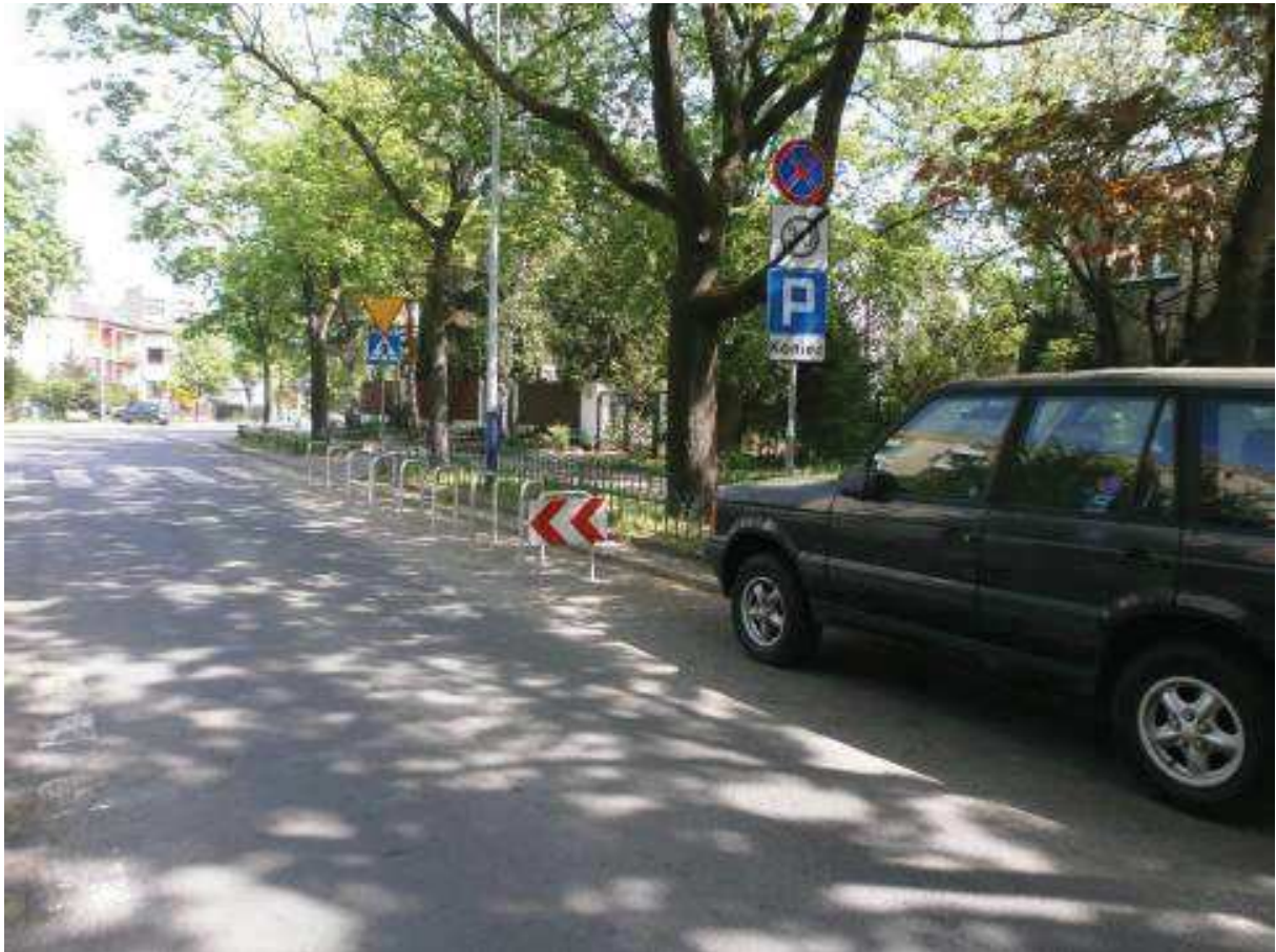
Ilustracja 10. Skracanie zatok parkowania i zwężenie przekroju jezdni ulicy przed skrzyżowaniami stojakami rowerowymi
