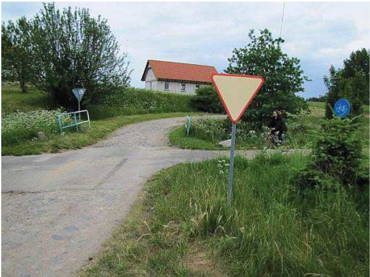
Ilustracja 18. Przykład przejazdu dla rowerzystów na skrzyżowaniu drogi dla rowerów z drogą ogólnodostępną z pierwszeństwem przejazdu drogi dla rowerów
